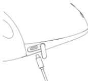
5. Inserte el lado pequeño del enchufe del cable en el conector tipo C del motor y luego conecte el puerto USB al banco de carga, computadora o conéctelo a la toma de corriente a través del adaptador (adaptador de 5V/1A).
